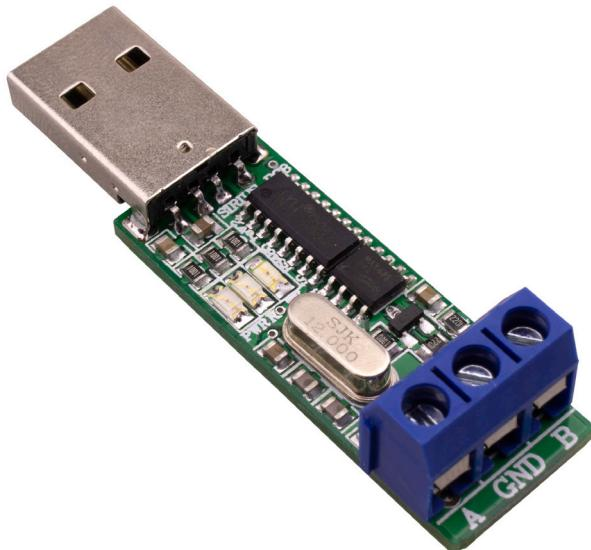
Устройството USB to RS485 rev.2 служи за осъществяване на връзка между компютър чрез USB порт и устройства с комуникационен канал RS485. Системата позволява включването на няколко интерфейсни контролера към един управляващ компютър. Устройството е базирано на чипа CH340G и MAX485.
